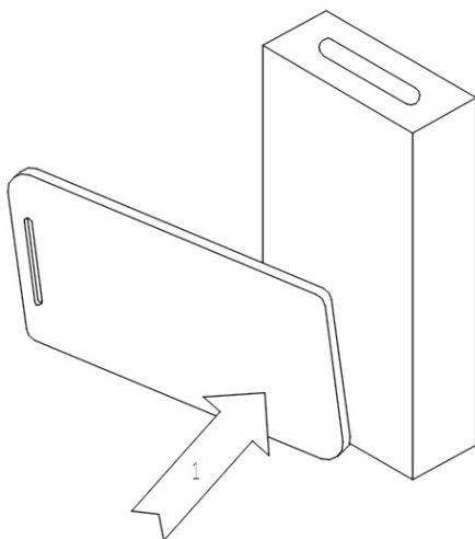
При поднесении идентификатора (карты) к лицевой поверхности считывателя воспроизводится звуковой сигнал, сопровождаемый повышением яркости световой индикации с изменением цвета свечения. Это означает, что идентификатор распознан считывателем и его данные переданы в контроллер СКУД.
