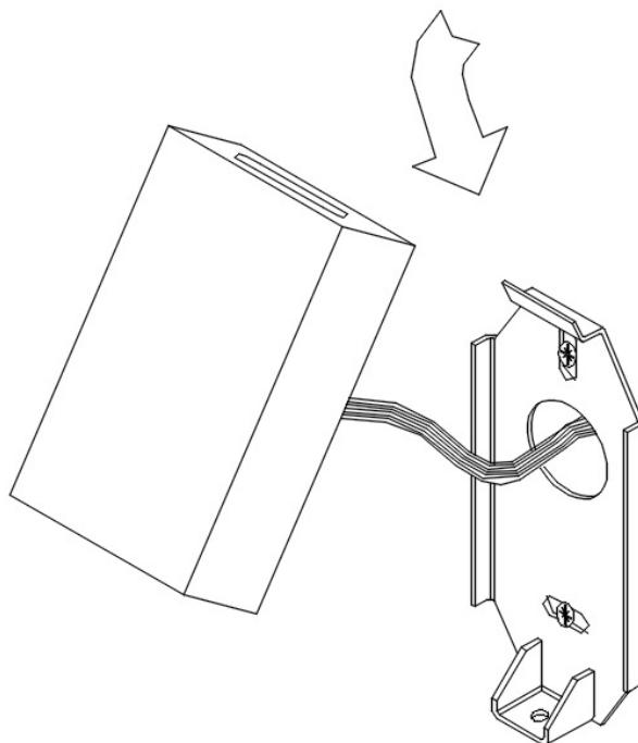
При правильной установке и соблюдении всех вышеуказанных требований и рекомендаций считыватель должен всем корпусом плотно прилегать к поверхности без перекосов и люфтов. Крепежный винт должен быть заподлицо с нижним торцом корпуса считывателя.
