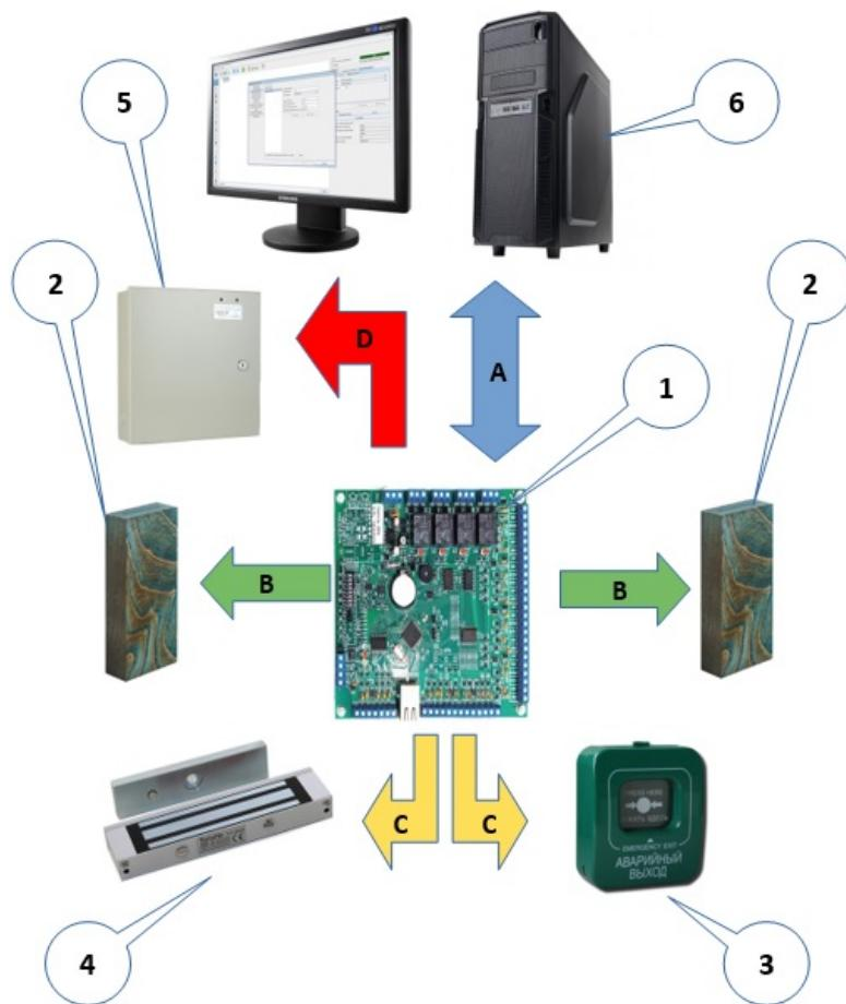
Устройство системы контроля и управления доступом и роли считывателей AGRG EYWA на примере СКУД Castle
